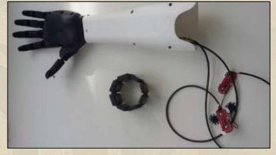
Az összeszerelt prototípus, Myo Armband-al
